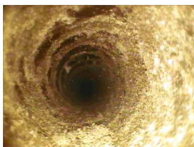
Figure 11 : Exemple d'observation endoscopique dans un matériau plein (type pierre pleine)
