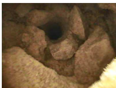
Figure 10 : Exemple d'observation endoscopique dans un matériau rocailleux
