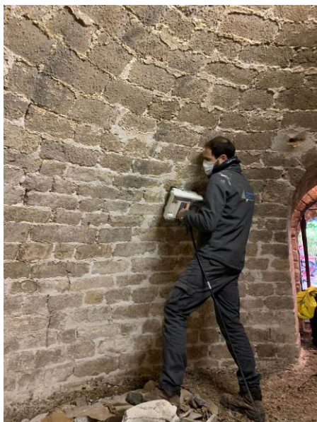
Figure 3: illustration de la mise en œuvre de l'antenne 900Mhz sur les murs et la voûte de la glacière
