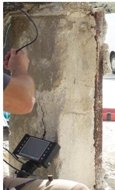
Figure 14: Mise en œuvre de l'endoscope iLed pour observation dans le socle d'une œuvre (sonde de 3 mètres béquillable)
