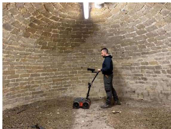
Figure 4: illustration de la mise en œuvre du radar GSSI avec l'antenne 350Mhz au niveau du sol
