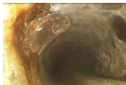
Figure 12 : Exemple d'observation endoscopique d'un acier corrodé dans un béton
